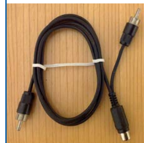
Bild 4 (unten): Y-Verbindungskabel zum Abgriff des PTT-Signals in der Funkstation
