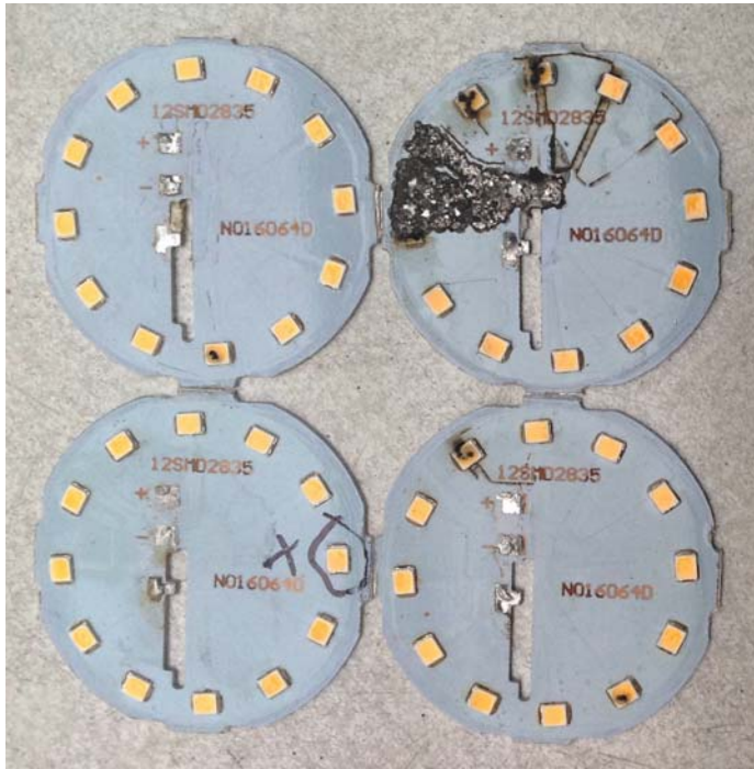
((Bild: LED-Scheiben mit defekten LEDs))
