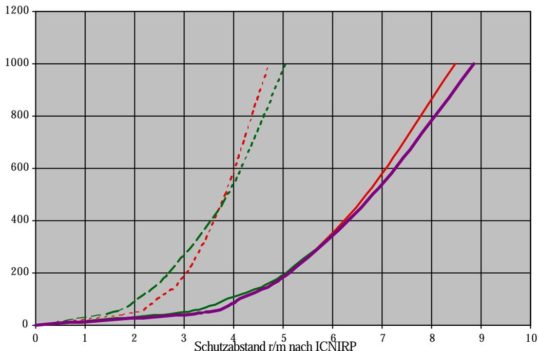
Bild 11.1 Gefittete Schutzabstandskurve  $r_{S \text{ PERS(BEMFV)}}$  (rechte dicke Kurve) für die Grundplane 4-BTV bei 7,05 MHz.
