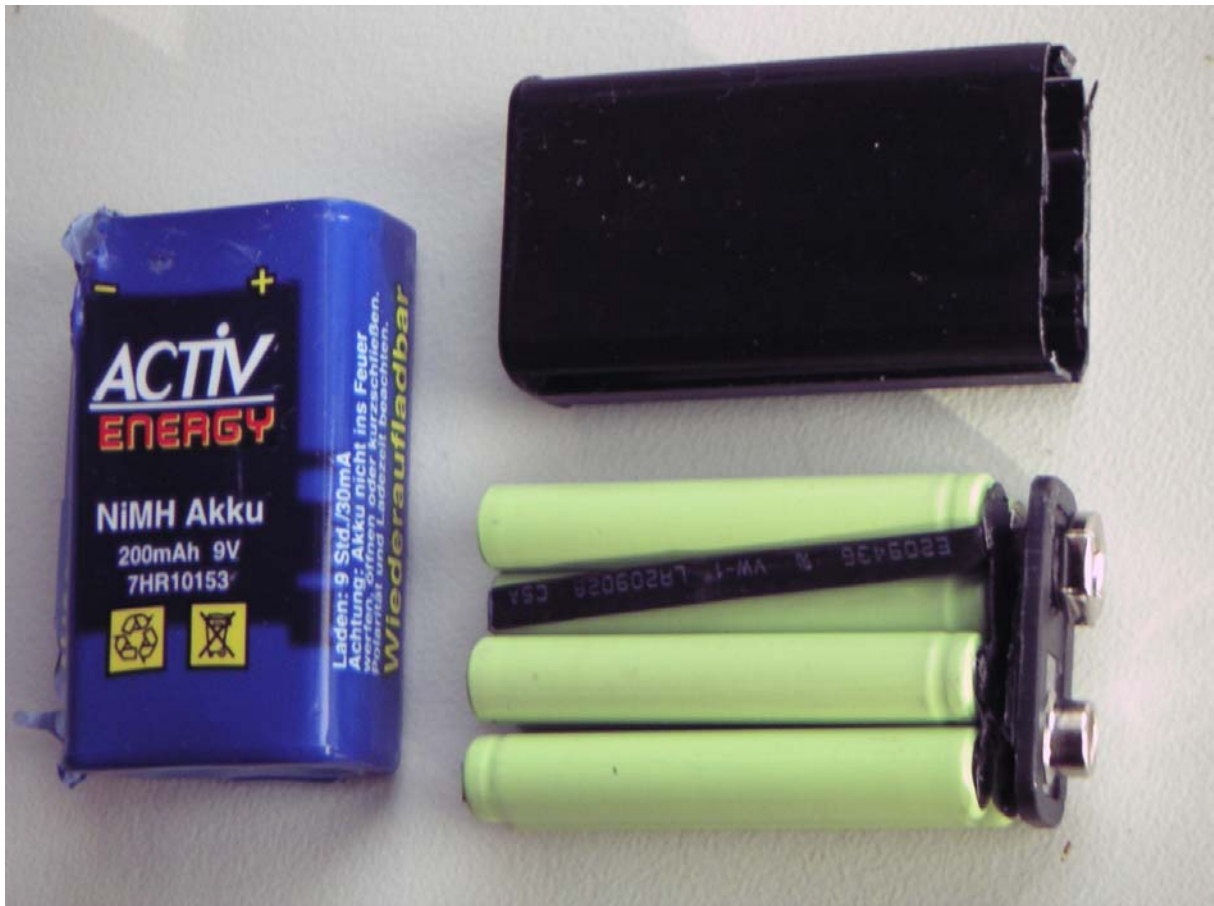
Bild 4: 9-Volt-Akku mit irreführender IEC-Bezeichnung. Die richtige Bezeichnung wäre 7HR 7/42
